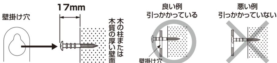
⚠ 注意 時計の壁掛け部以外に掛け具(ねじ)を掛けしないでください。時計の落下により、物品の損傷やけがの原因になります。
