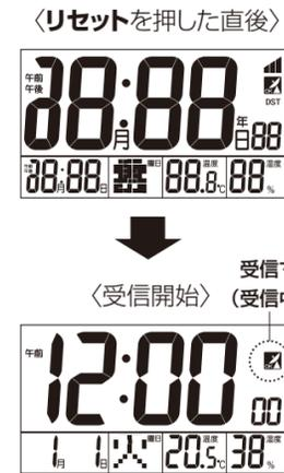
電源投入直後およびリセットを押した直後は、2008年1月1日、午前12:00に設定されます。
