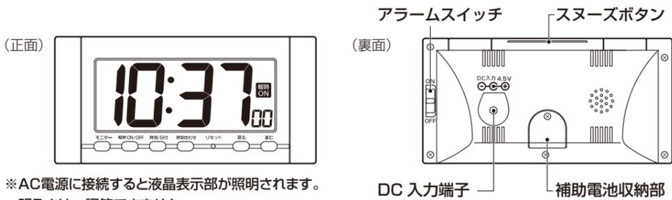
※AC電源に接続すると液晶表示部が照明されます。明るさは、調節できません。
