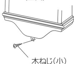
扉の開閉時に時計が傾くのを防止するため、時計裏面の振れ止めを左図のようにしてから垂直に掛け、木ねじ(小ねじ)で固定してください。
