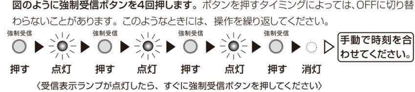
※電波受信機能がOFFのときに強制受信ボタンを押すと、受信表示ランプは消灯したままで、針が早送りで動いたり、止まったりしてから時刻を表示します。
