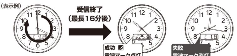
強制受信を押すと針が早送りで4、8、12時のいずれかに移動して停止
