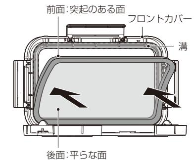
② 操作シートの枠全周をフロントカバーに押し込んで、確実に固定させてください。
