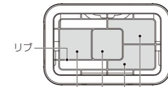
カメラのレンズなど、突起物が図の位置に納まるように配置してください。
