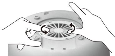
②止まったところでロックが解除されますので、吸気口カバーを持ち上げて取り外します。
