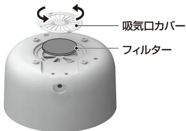
①吸気口カバーを反時計方向に回します。
