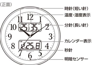
液晶表示は、時計を掛けて少し見上げる位置がクッキリと見やすくなっています。使用している液晶の特性上、他の方向から見ると、表示が薄くなったり、むらになったりすることがあります。
