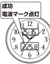
受信に成功すると電波マーク
