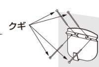
取付金具の穴に対して、垂直に押し込む
