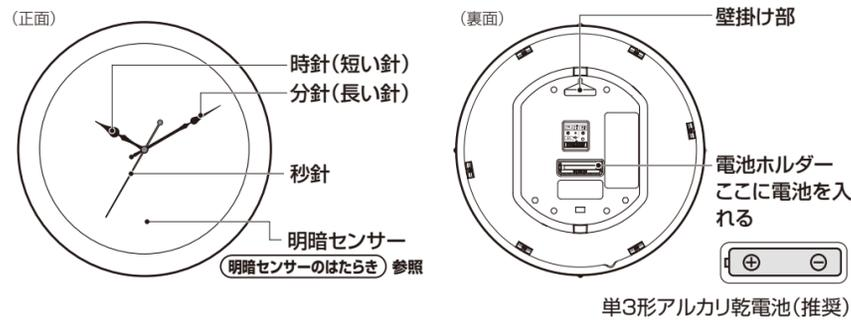
**注意** 電池の+と-を指示と逆向きに入れると、電池の液漏れ・発熱・破裂の原因となります。
